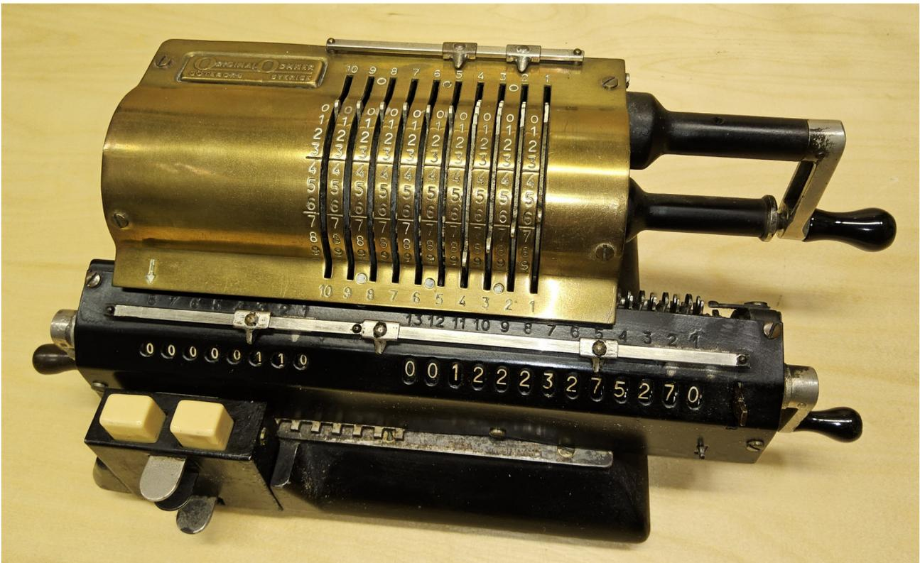
Die Odhner 127 ist eine Vierspezies-Sprossenradmaschine, ein Standardmodell der 50er Jahre mit Rückübertragung.
