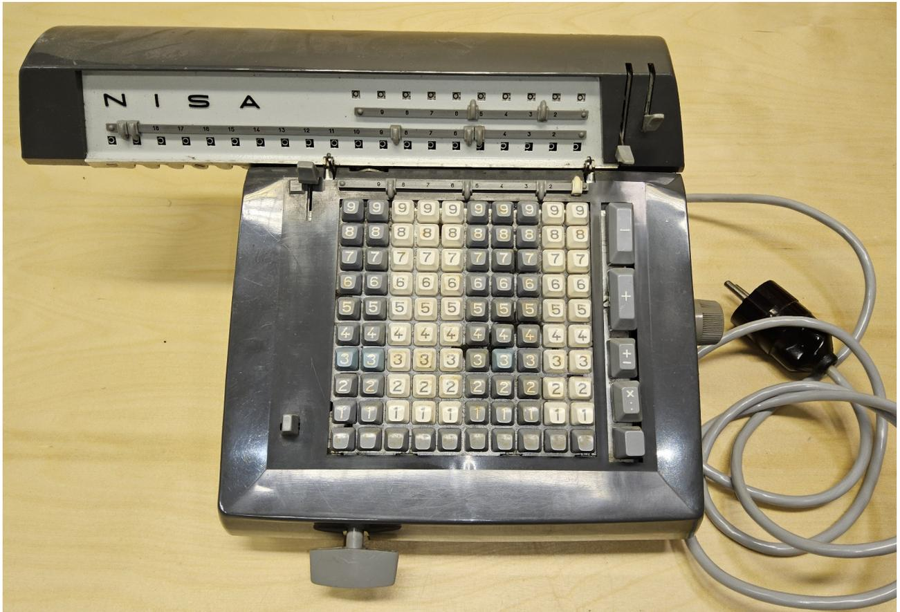
Die Nisa PK 5 ist eine elektromechanische Vierspeziesmaschine, ein Halbautomat mit geteilten Staffelwalzen.
