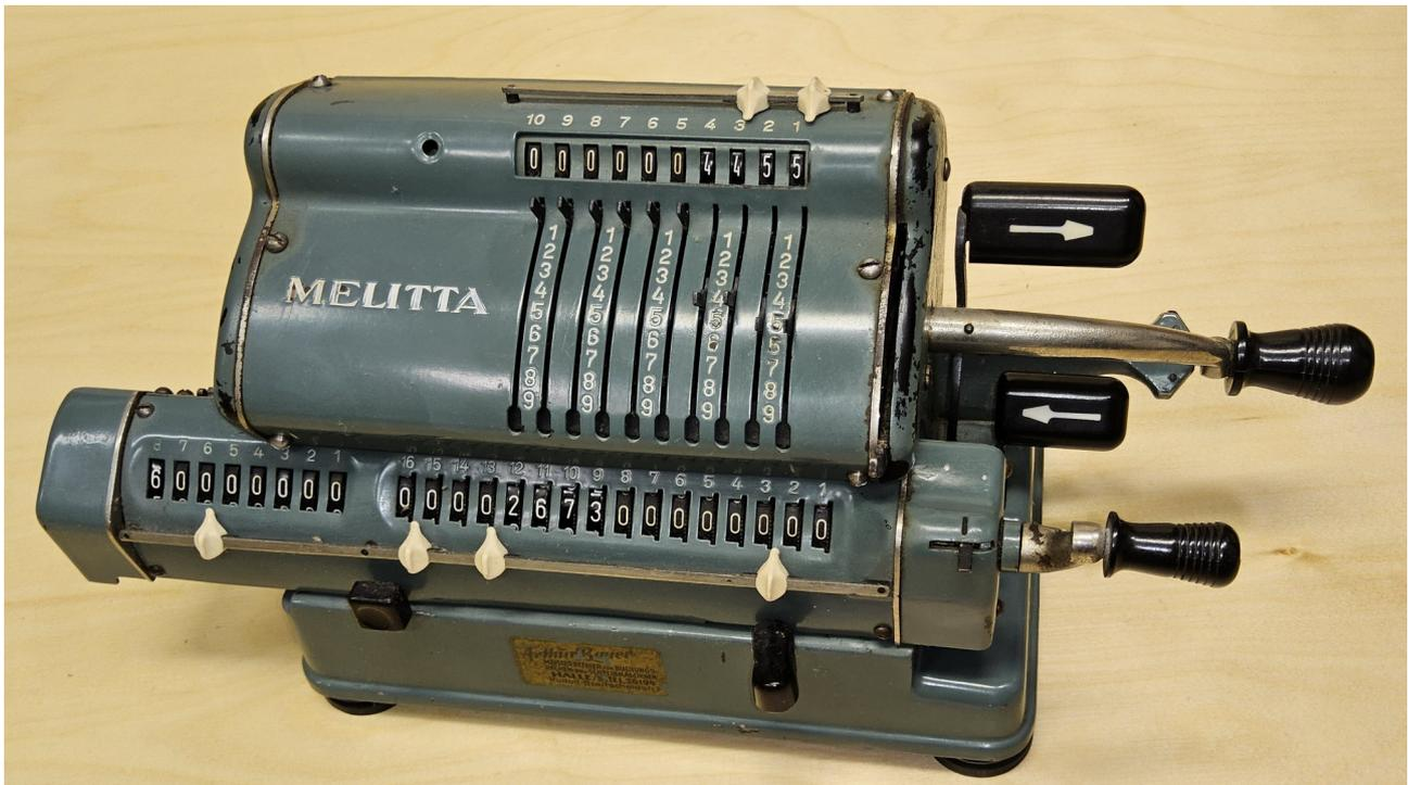
Die Melitta VII/16 ist eine 4-spezies Sprossenradmaschine. Sie ist die letzte Ausbaustufe der von den Fortuna Werken gebauten Sprossenradmaschinen.
