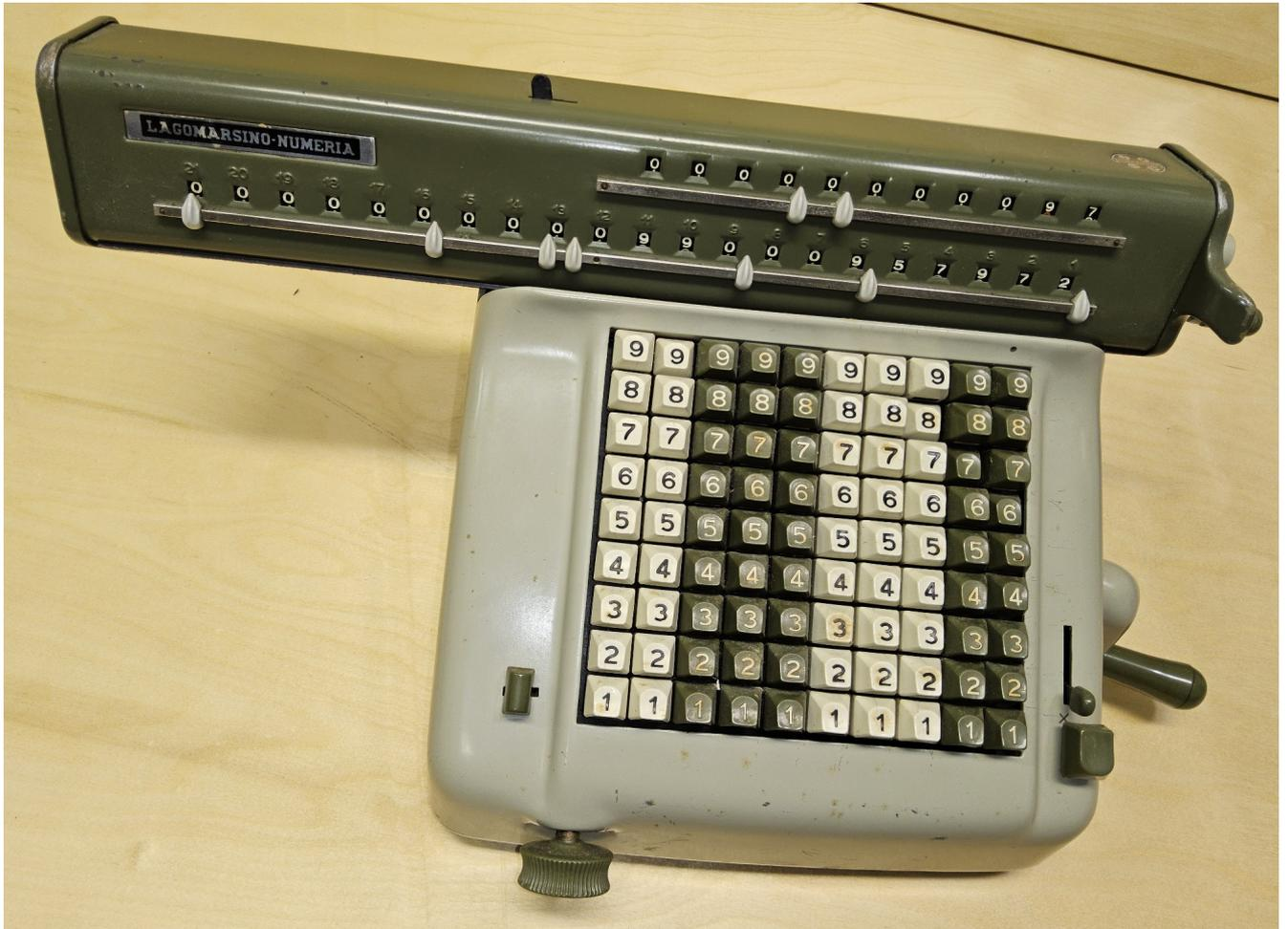
Die Lagomarsino Numeria 5903 ist eine Schwenk-Sprossenradmaschine mit Volltastatur. Sie besitzt eine automatische Tastenfeldlöschung nach jedem Rechengvorgang und eine Löschkurbel für Umdrehungs- und Resultatwerk.
