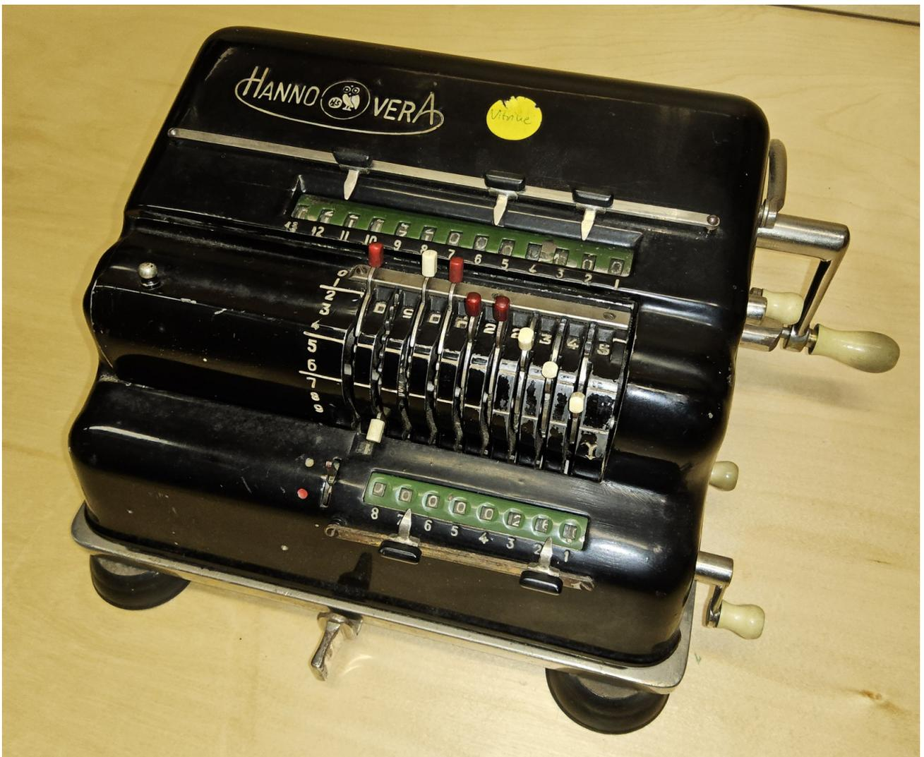
Die Hannovera CK ist eine 4-stufige Stellsegmentmaschine.
