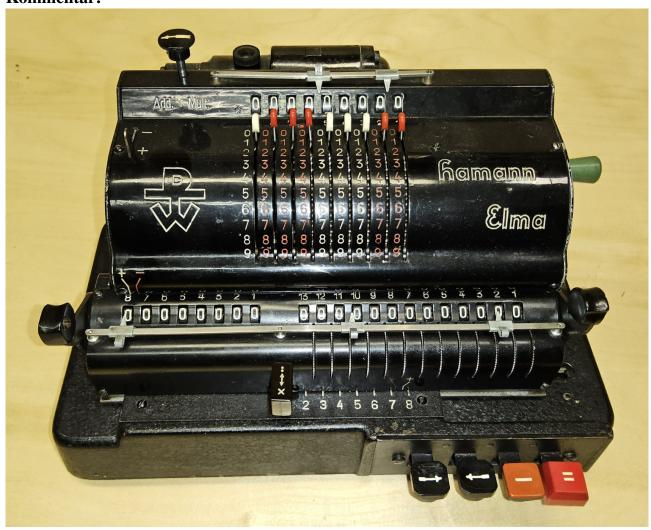
Die Hamann Elma ist eine elektromechanische Schaltklinkenmaschine.
