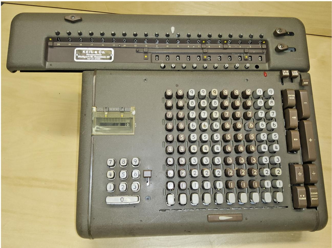
Die Friden SW 10 ist eine vollautomatische Vierspezies-Staffelwalzenmaschine mit Volltastatur.
