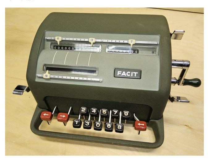
Die Facit NTK ist eine mechanische Vierspezies-Rechenmaschine mit geteilten Sprossenrädern und Zehnertastatur.
