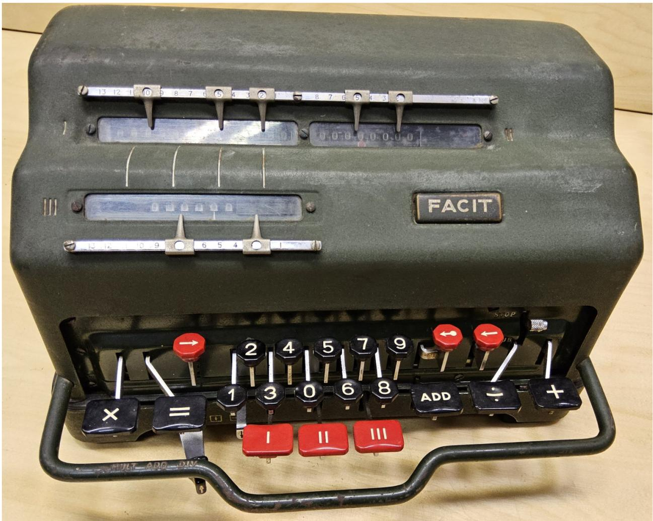
Die Facit ESA-01 ist eine elektromechanische Vierspezies-Rechenmaschine mit geteilten Sprossenrädern und Zehnertastatur.
