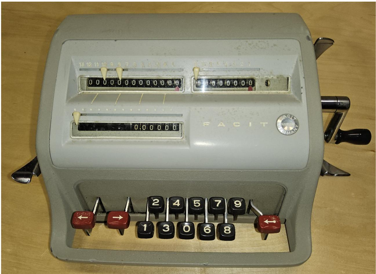
Die Facit C1-13 ist eine mechanische Rechenmaschine mit geteilten Sprossenrädern. Ungewöhnlich für Sprossenradmaschinen ist die Zehnertastatur.
