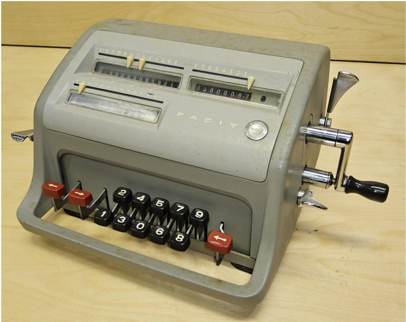
Die Facit C1-13 ist eine mechanische Rechenmaschine mit geteilten Sprossenrädern. Ungewöhnlich für Sprossenradmaschinen ist die Zehnertastatur.
