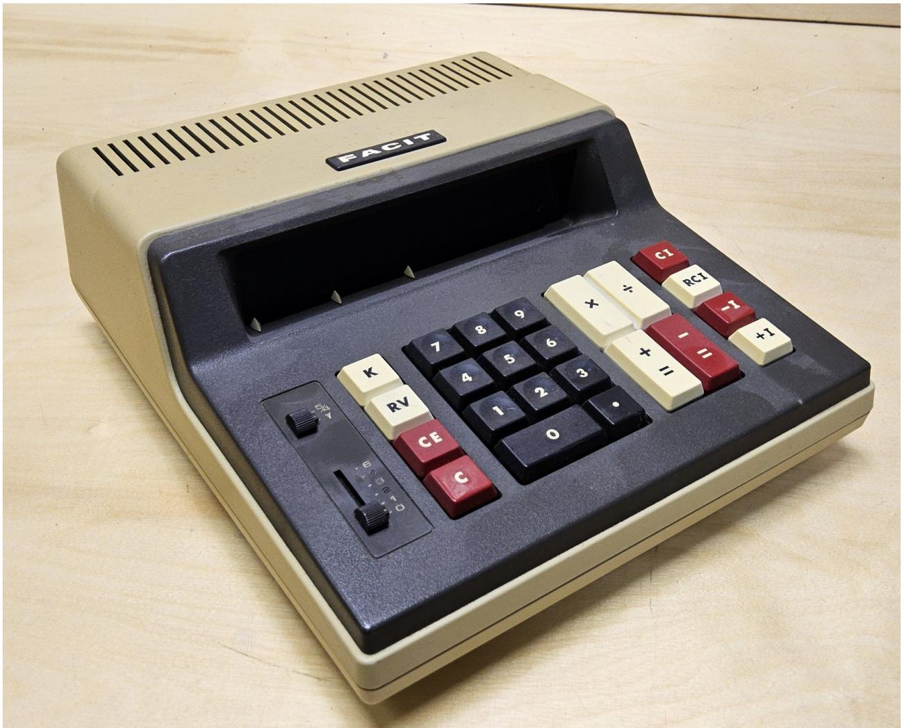
Der Facit 1118 ist ein 12-stelliger anzeigender Tischrechner mit Digitron-Display, von 1972. Zum Funktionsumfang des Rechners gehören neben den Grundrechenarten ein Speicher mit vier Tasten, ein Konstanten-Speicher, [Registertausch](#) (die [RV]-Taste) und kaufmännisches
