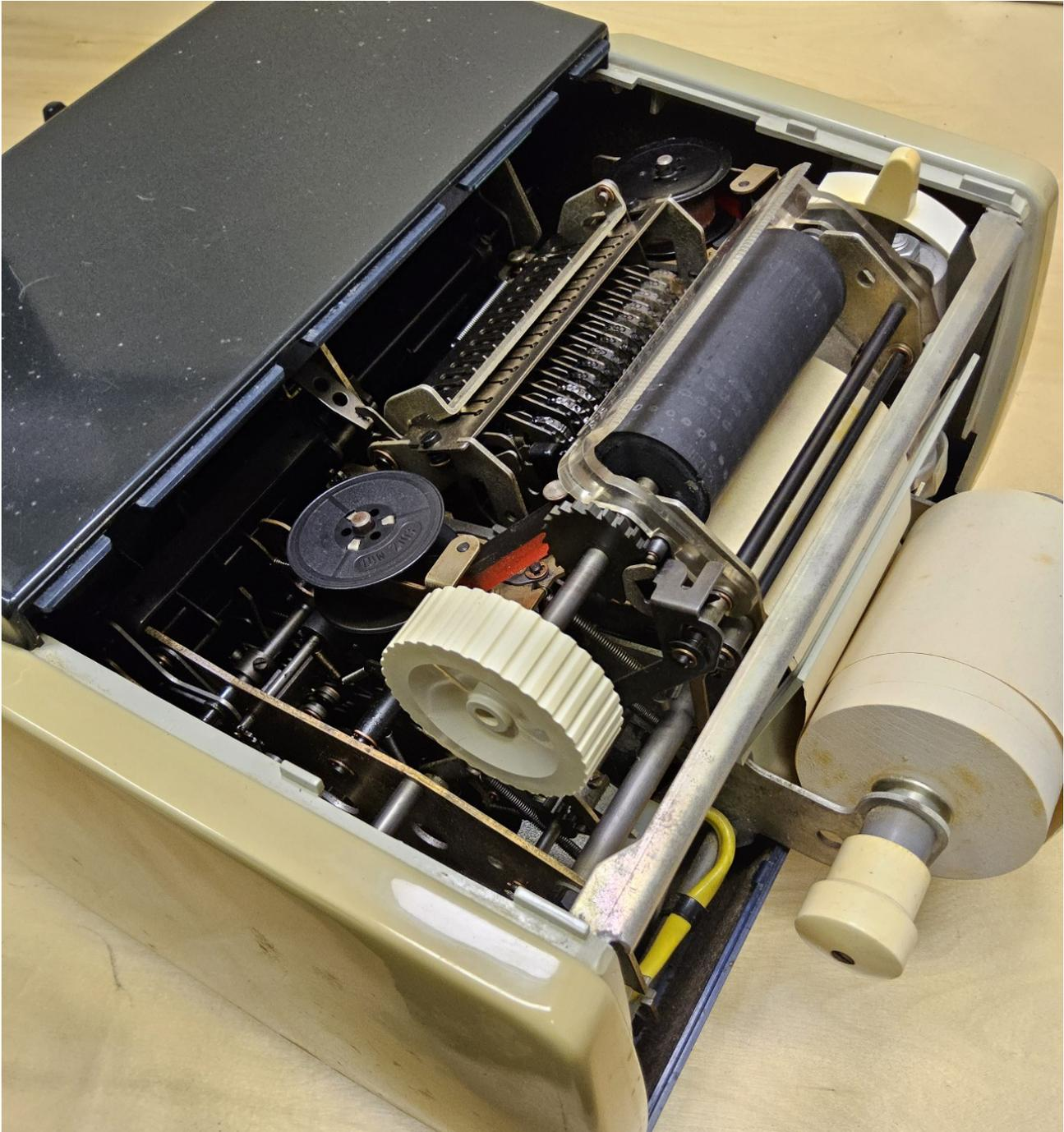
Der "Standardrechner" DIEHL decima mit Komma-Automatik besitzt eine Schnellrecheneinheit, die vollautomatisch multipliziert und dividiert. Eine Speichereinheit addiert, subtrahiert und speichert Resultate. Der Druckspeicher hält jeden Wert nach Abdruck zur Weiterverarbeitung bereit und ermöglicht beliebige Übertragungen zwischen Schnellrechen- und Speichereinheit. Eine echte Komma-Automatik bringt
