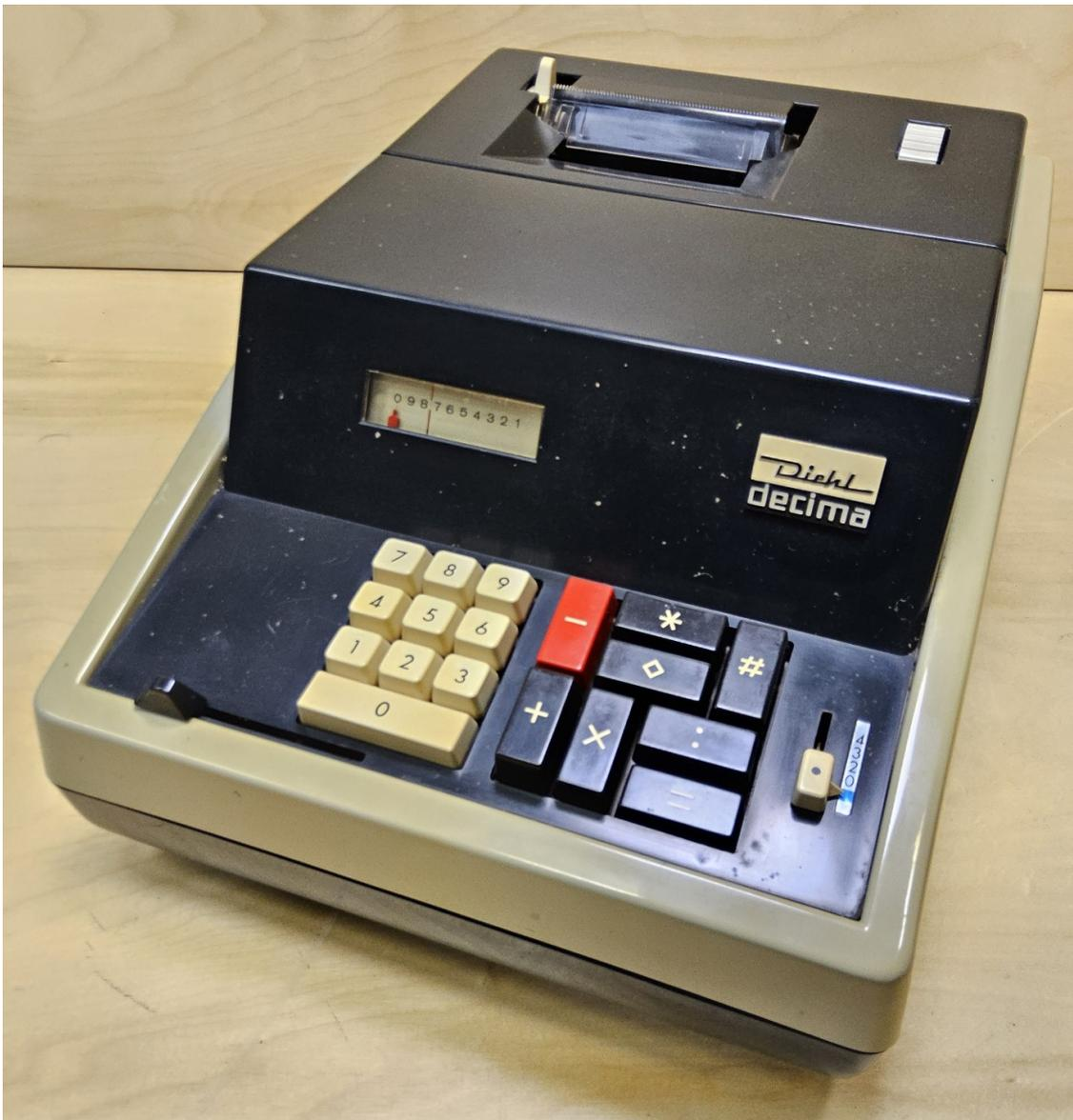
Die Diehl Decima ist eine druckende Zahnstangenmaschine mit Sprossenrädern.
