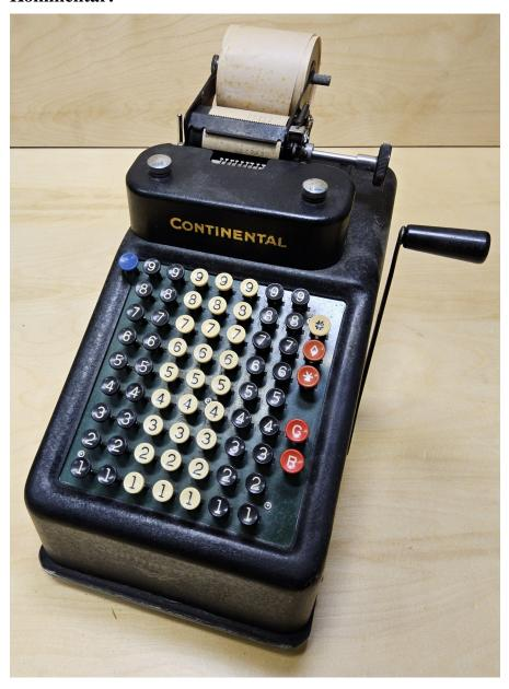
Die Continental 8 ist eine Einspezies-Addiersegmentmaschine mit Druckwerk.
