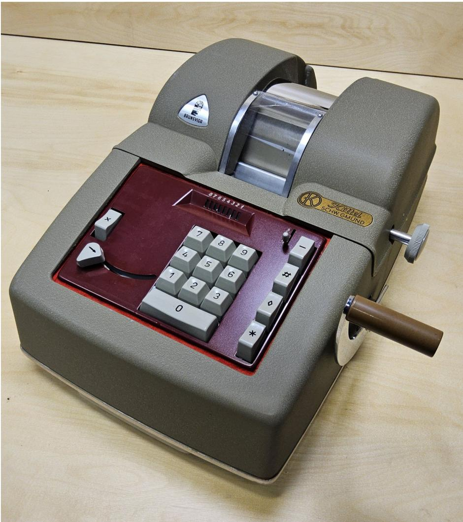
Die Brunsviga G 89 ist eine mechanische, druckende Zweispezies Addiersegmentmaschine aus dem Jahr 1956.
