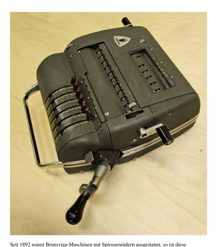
kompakte Brunsviga-Rechenmaschine mit geteilten Staffelwalzen ausgeführt. Das Vorgängermodell dieser Maschine war die Brunsviga Modell 10, das ab ca. 1932 gebaut wurde. Deshalb wird dieses Modell auch Nova B10 bezeichnet.
