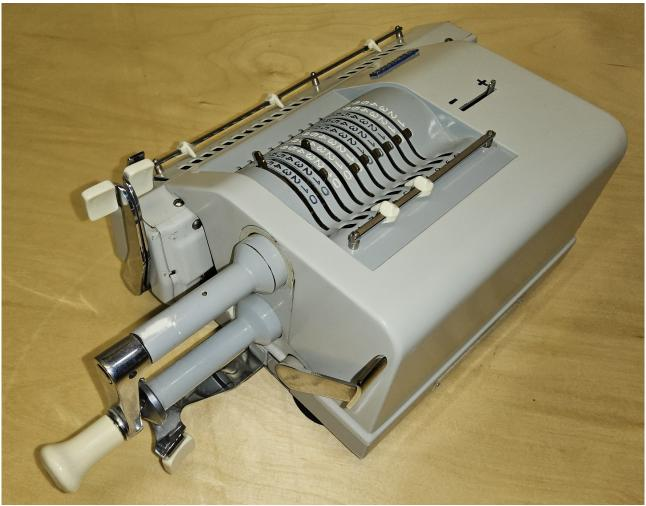
Zum Funktionsprinzip: Das Sprossenrad ist ein Zahnrad, dessen Zähne durch Ein und Ausfahren zwischen null und neun Zähnen variiert werden können. Erfunden 1709 von Poleni in Padua. Nachteil: die Einstellhebel einer Sprossenradmaschine drehen sich beim Drehen der Kurbel mit.
