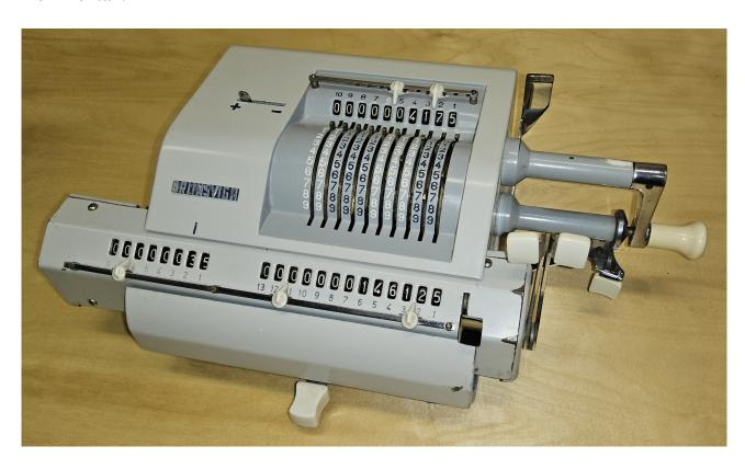
Die Brunsviga 13 RM ist eine mechanische Vierspezies-Sprossenradmaschine mit Rückübertragung, daher das "R" im Nahmen. ("M" für mechanisch)
