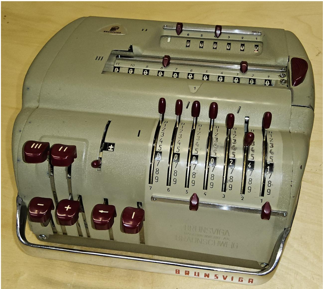
Die Brunsviga 11E ist eine elektrische Vierspeziesmaschine mit geteilten Staffelwalzen.
