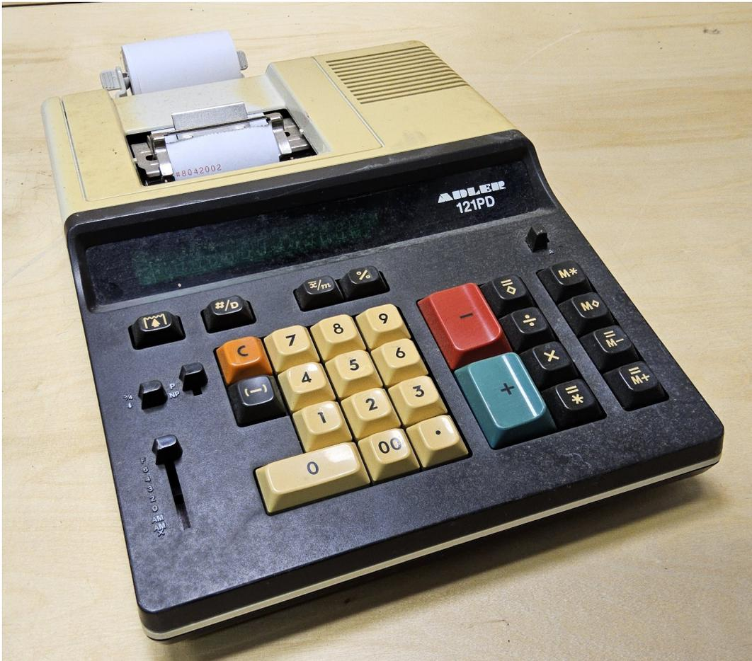
Der Triumph-Adler 121 PD (CP46(3)) ist ein Tischrechner mit 12-stelliger Leuchtanzeige und einem schnellen, zweifarbigen Druckwerk.
