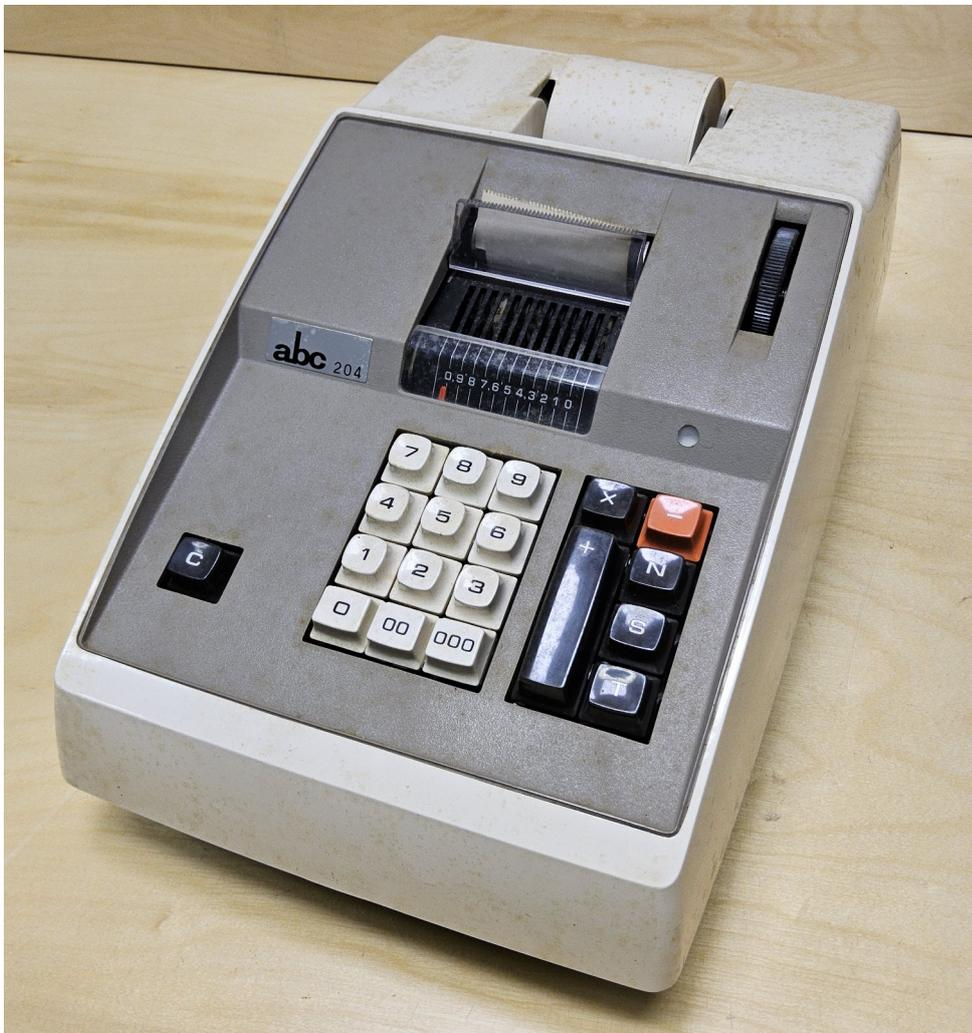
Die ABC 204 ist eine druckende Zweispezies-Addiersegmentmaschine. Sie ist nach dem Zahnstangenprinzip aufgebaut und motorbetrieben. Das Eingabewerk umfaßt 10 Stellen, das Rechenwerk 11 Stellen. Die ABC ist eine saldierenden Maschine für den kaufmännischen Einsatz.
