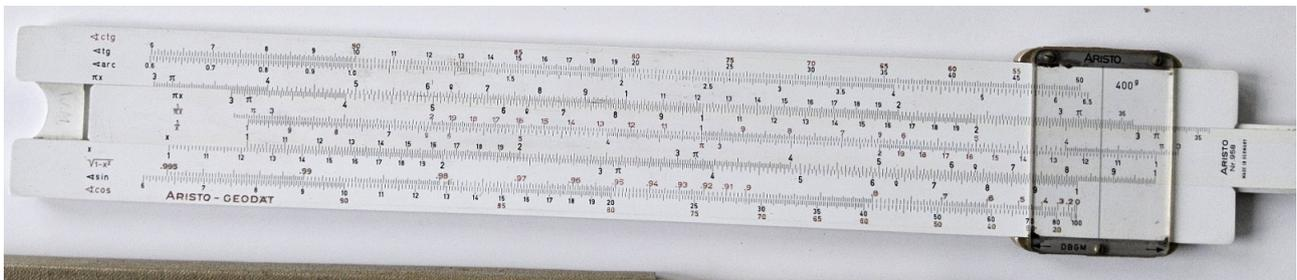
Der Aristo Geodät ist ein Zweiseiten Rechenschieber mit zusätzlichen Skalen für spezielle Aufgaben des Vermessungsingenieurs.
