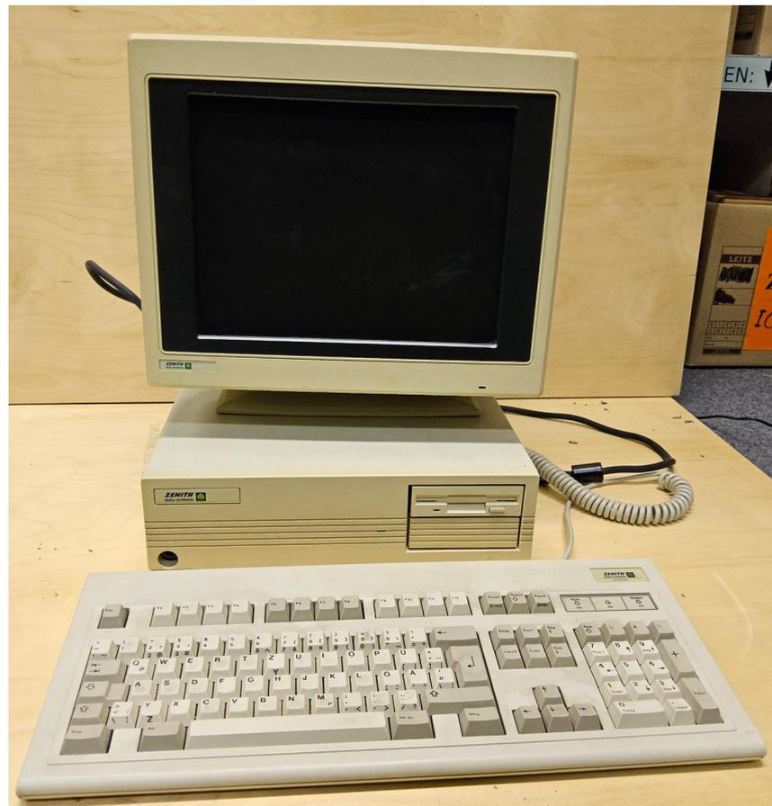
Bei dem Zenit ICV-2521-EC handelt es sich um ein Computersystem mit einem 80286 12MHz Intel Prozessor und 640KB RAM.
