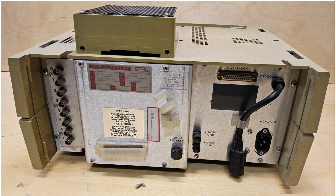
**R2076 REMOTE CONTROL UNIT:** Ein kleiner Cluster Controller, der bis zu acht Geräte in einem IBM-Netzwerk 3276-Typ-Netzwerk bedient. Das Gerät enthält integrierte Diagnose- und Selbsttestfunktionen.
