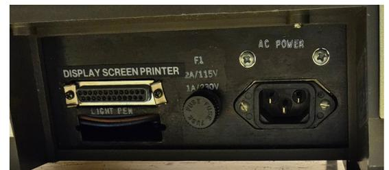
**R2078 ANZEIGETERMINAL:** Das Terminal ist mikroprozessorgesteuert und enthält seinen eigenen Speicher - 16K Bytes RAM und 8K Bytes ROM.
