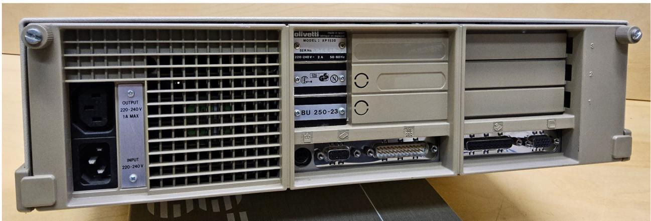
Der M250 vereinte die damals neuen Marktstandards im Bereich der professionellen Datenverarbeitung mit einem 8 Mhz schnellen 80286-Mikroprozessor mit "Zero Wait-State"; 1 MB RAM-Speicher; 3,5"-Diskettenlaufwerk; 16-Bit-AT-Erweiterungsbus und der Möglichkeit, sowohl mit MS-DOS als auch mit MS OS/2 zu arbeiten.
