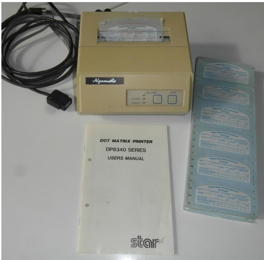
Der Star DP8340 war mit einem bidirektional druckenden 9-Nadel Druckkopf ausgestattet. 40 Spalten konnten mit einer Auflösung von 12 CPI , zweifarbig gedruckt werden.
