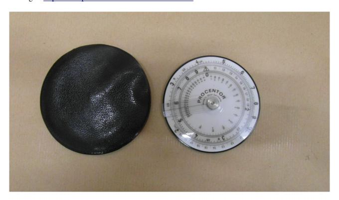
Mit dieser Rechenscheibe können laut beiliegender Beschreibung Multiplikation und Division, Dreisatz- und Prozentrechnung ohne jegliche Vorkenntnisse durchgeführt werden. Die logarithmische Teilung der gegeneinander verdrehbaren Skalen zeigt auf, dass das Funktionsprinzip dem des Rechenschiebers entspricht die runde Form dürfte hauptsächlich der Handlichkeit halber gewählt worden sein.
