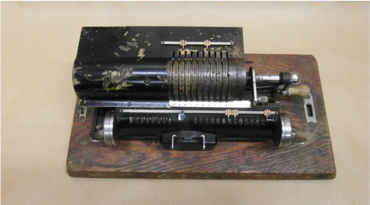
Vierspezies-Sprossenradmaschine, 9x8x13, ohne Einstellkontrollwerk, mit Zehnerübertrag im Umdrehungszählwerk, mit Kastenschloss.
