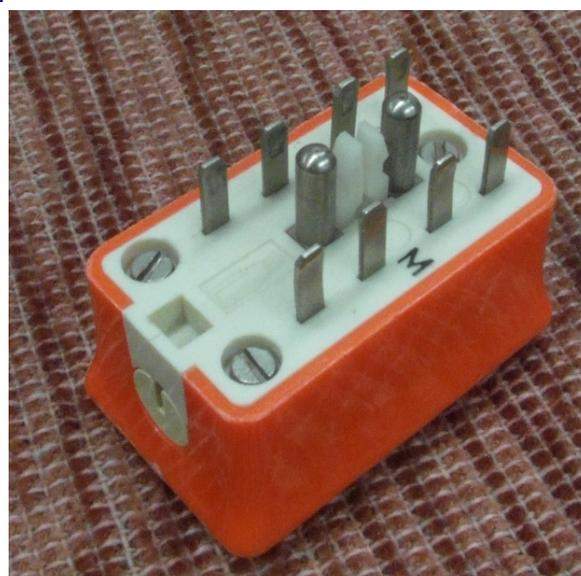
Dieser Teststecker brückt sämtliche Kontakte.
