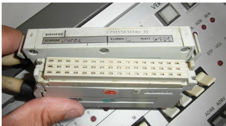
2 Anschlußkabel mit je 3 Reihen zu 16 Leitungen.
