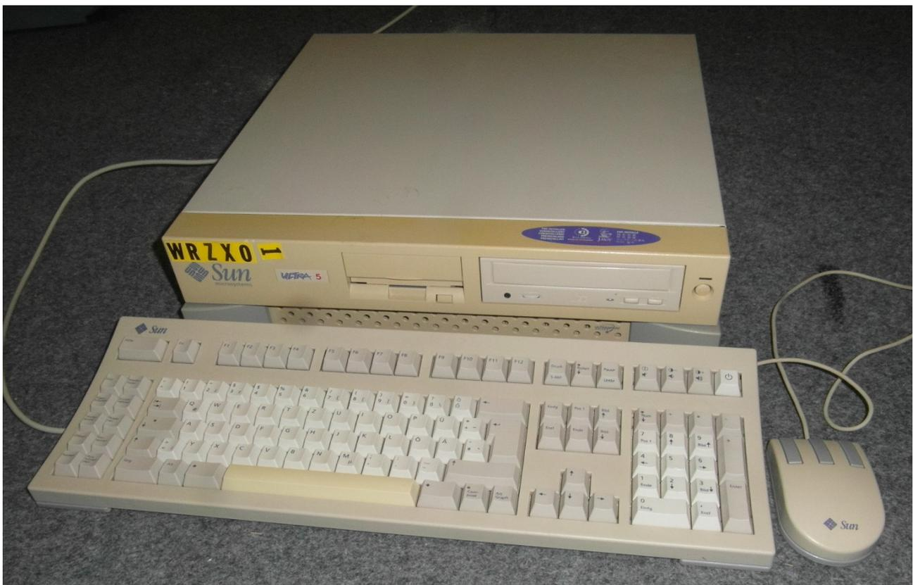
Das System zeichnet sich dadurch aus, dass es aus der ersten der Sun Workstation-Reihe stammt, die verschiedene PC-kompatible Hardwarekomponenten wie ATA-Festplatten mit CMD640 PCI EIDE-Controller und einen ATI Rage PRO-Grafikchip einführt.
