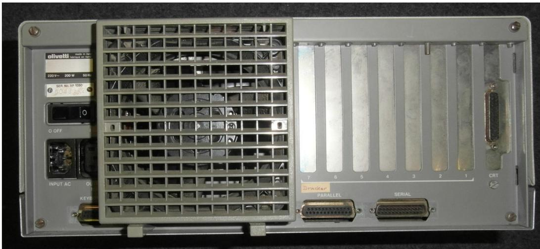
Der erste moderne Personal Computer von Olivetti, der Olivetti M20, ausgestattet mit einer Zilog Z8000 CPU, wurde 1982 auf den Markt gebracht. 1983 brachte Olivetti den M24 auf den Markt, einen Klon des IBM-PCs mit DOS und dem Intel 8086-Prozessor (mit 8 MHz) anstelle des von IBM verwendeten Intel 8088 (mit 4,77 MHz). Standardmäßig hatte der M24 eine 20MB MFM Festplatte und 512K RAM.
