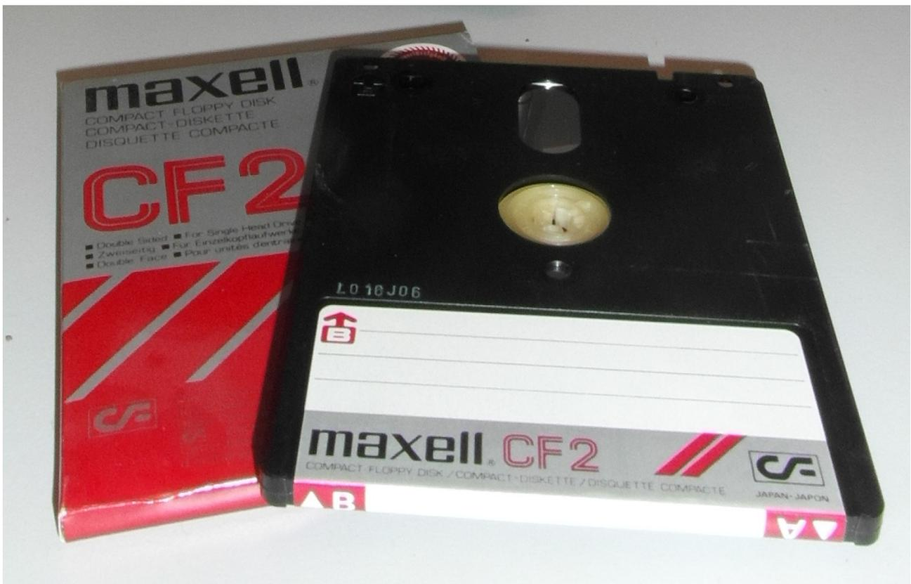
Diese Datenträger wurden in einer Papierhülle oder einem harten Kunststoffgehäuse geliefert, das einer "Jewel"-Hülle für Compact Discs ähnelte. Das Gehäuse ist dicker und steifer als das von 3,5"-Disketten, und die verschiebbare Metallabdeckung zum Schutz der Medienoberfläche befindet sich im Inneren des Gehäuses und ist verriegelt, im Gegensatz zu
