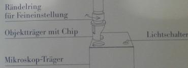
Stecken Sie nun das Mikroskop in die Öffnung des Mikroskop-Trägers (das schwarze Kästchen), in der sich bereits der auswechselbare Objektträger mit dem 256-K-Bit-Chip befindet.
