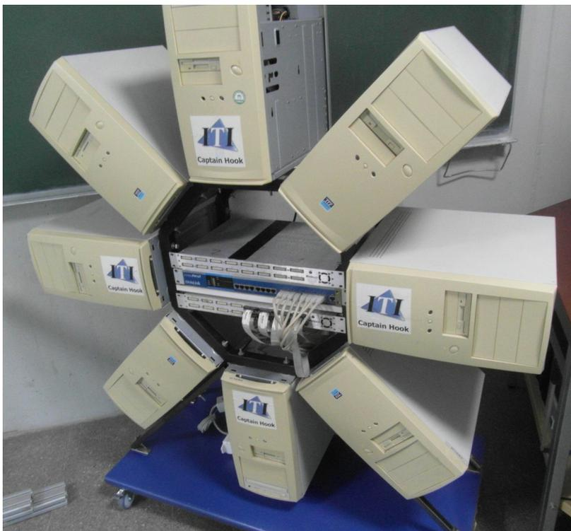
Dieser Rechner ist ein, von der Bauform, sehr eindruckvolles Beispiel eines so genannten "Beowulf-Clusters".
