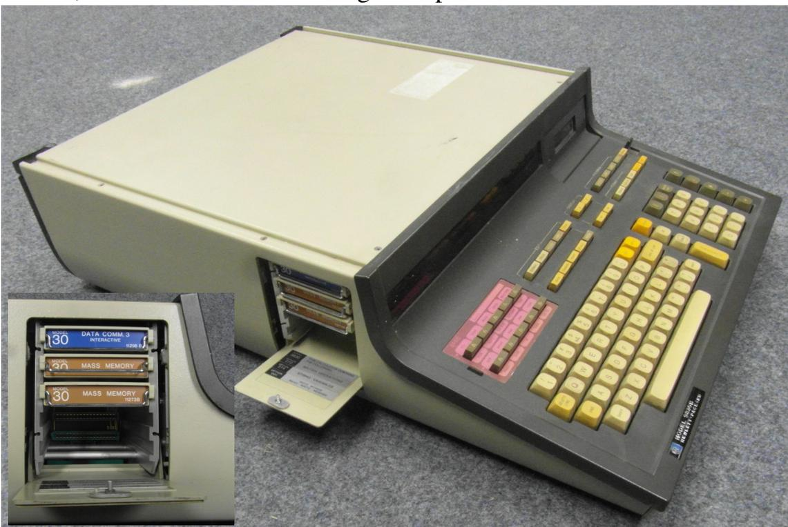
Bei dem unter I1893a Inventarisierten Modell befinden sich in dem seitlichen Erweiterungs-Einschubfach 3 Module.
