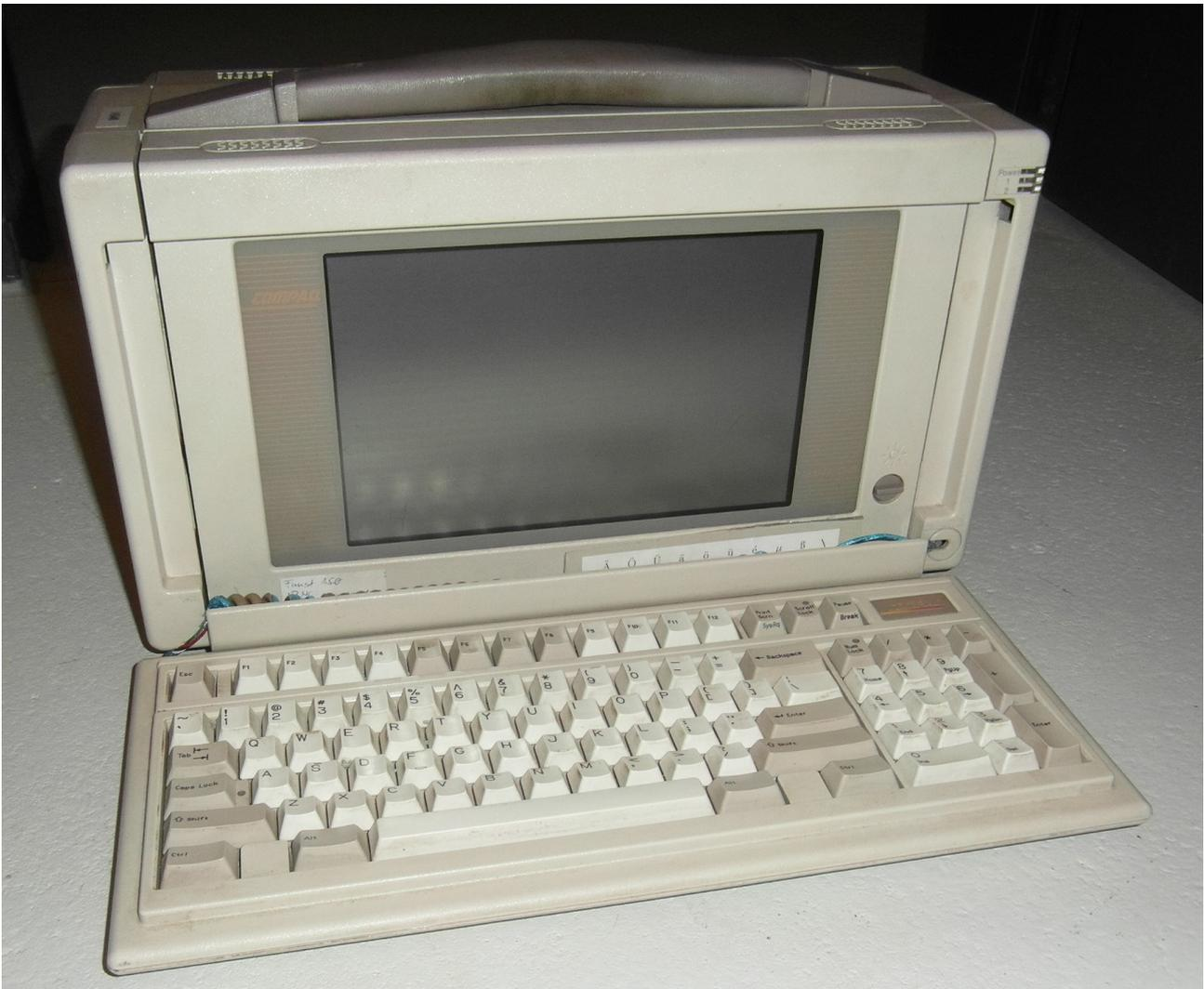
Er ist einer der letzten Vertreter der „Koffercomputer“. Der Rechner besitzt er keinen Akku und wird von einem AT-Computernetzteil mit Strom versorgt.
