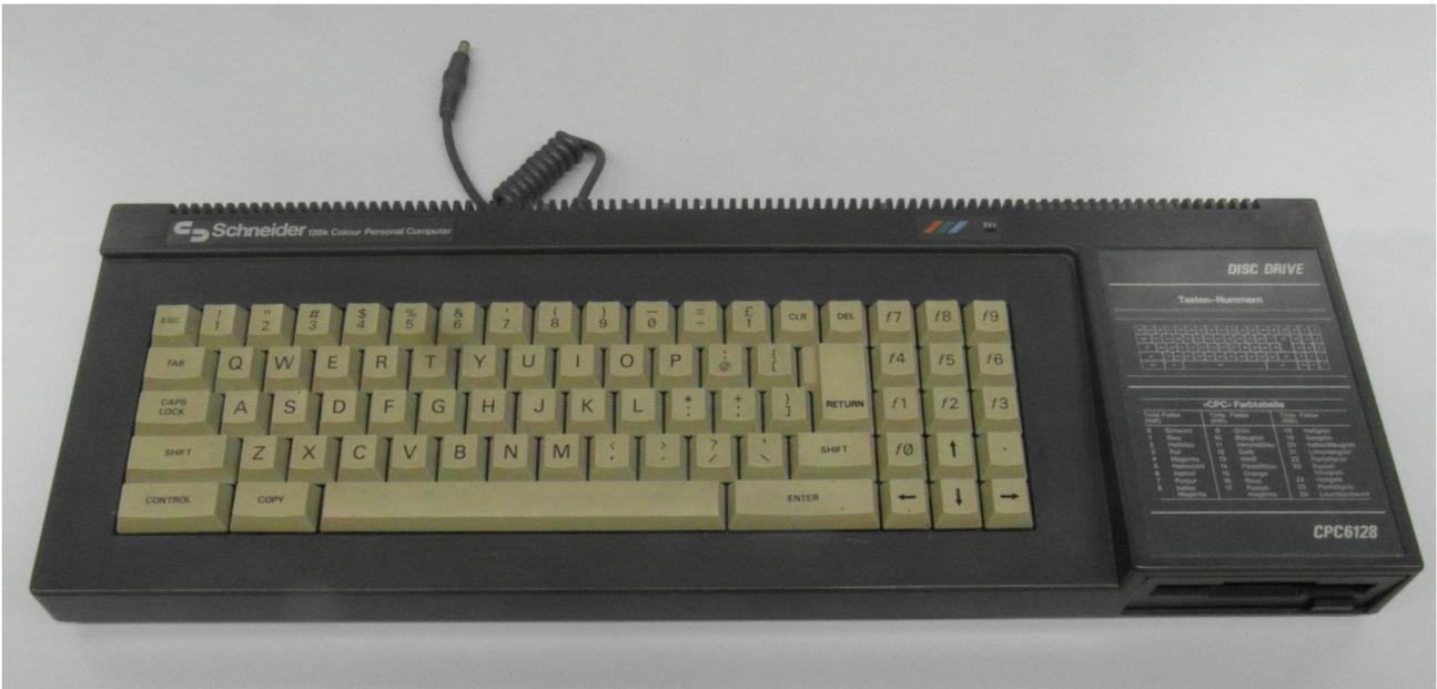
Hatte der CPC464 noch eine Datasette als Speichermedium ging Schneider mit dem neuen Modell mit der Zeit und spendierte ihm ein internes Floppy-Disk Laufwerk. Allerdings setzten sie nicht auf die herkömmlichen 3,5“ Laufwerke, sondern auf 3-Zoll-Diskettenlaufwerk von Hitachi, als der Rest der PC-Industrie auf das 3,5-Zoll-Format von Sony umstieg. Die Entscheidung wird oft damit begründet, dass Amstrad in Asien eine große Lieferung von 3-Zoll-Laufwerken gekauft hatte.
