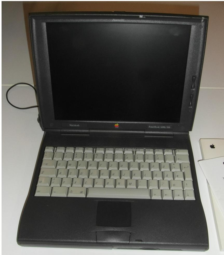
Bei seiner Markteinführung 1996 war das 1400c eines der ersten Geräte mit einem Wechselschacht für Laufwerke. Dieser war serienmäßig mit einem CD-ROM-Laufwerk bestückt, das gegen ein Diskettenlaufwerk getauscht werden kann.
